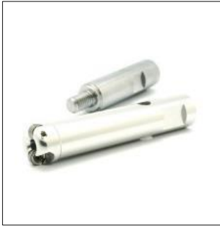
제품명 : 크랙커터(MP21-16) 규격 : 20x20x100mm 날판직경 : 20mm 회전속도 : RPM 11000 - 15400
